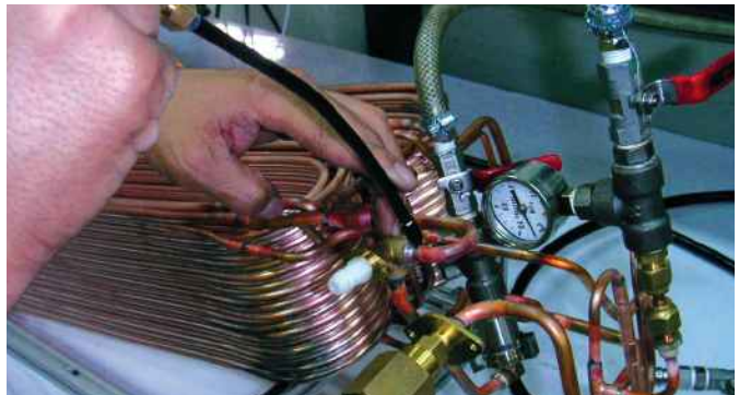
プローブでワークのリーク箇所を特定している様子
