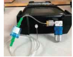
サンプリングホースにはエアコンオイル除去フィルターが付いており、分析器をオイルから守ります。(消耗品)
