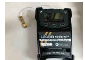
タンク接続用のフィッティングアダプター付属。
